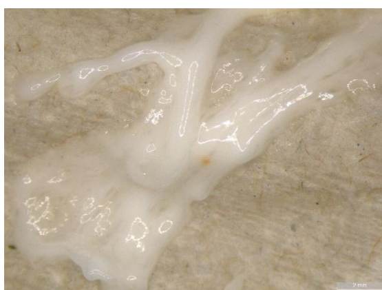
Figure IV-8 : EPDM C après test en immersion à 70°C
