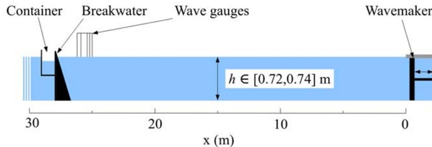
*Figure 2. Schéma indicatif du canal-soufflerie de l'OSU Pythéas indiquant la position de la digue et des instruments de mesure. Une unité verticale vaut 5 unités horizontales.*
