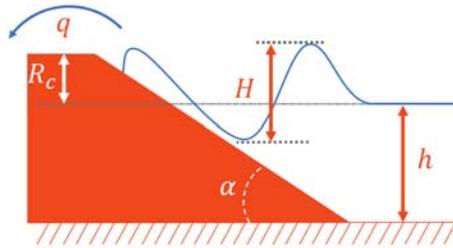
*Figure 1. Schéma du processus de submersion d'une protection côtière par les vagues. La digue orange illustre les proportions de la pente de la digue considérée dans notre étude ( $\cotan \alpha = 3/2$ ).*
