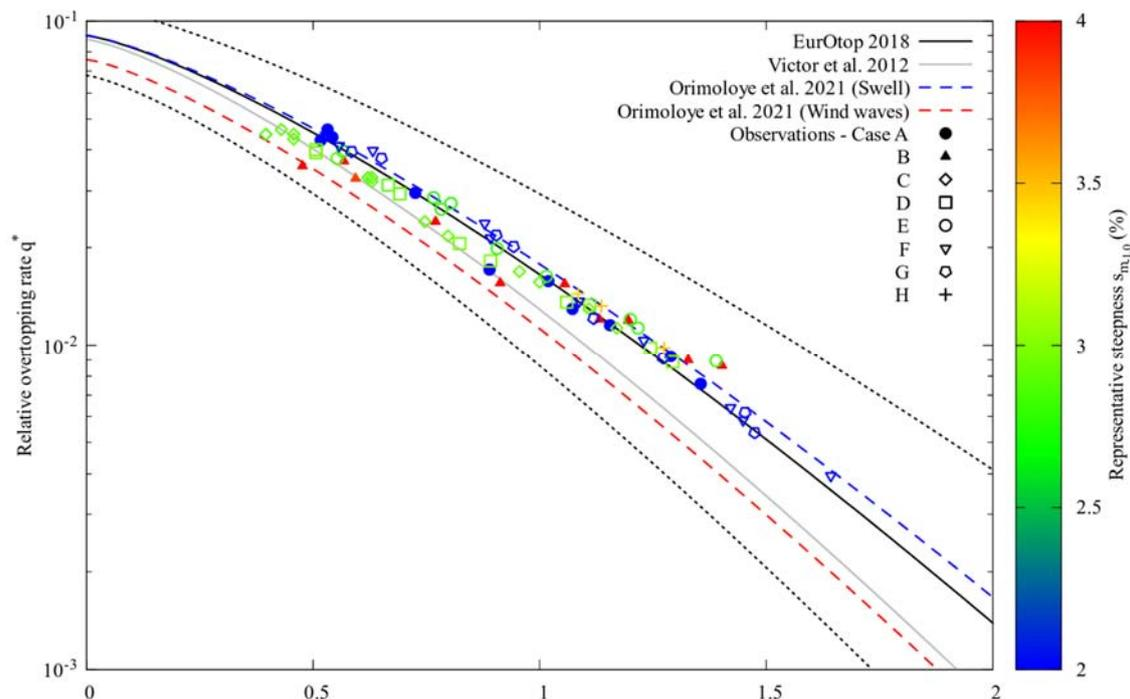
*Figure 4. Débit de franchissement adimensionnel en fonction de la hauteur de franc-bord adimensionnelle de la digue lisse. Chaque point correspond au résultat d'un essai de 30 min. Les points sont colorés par la cambrure représentative de l'état de mer. La courbe en pointillés noir représente l'intervalle de confiance à un niveau de précision de 90 %.*
